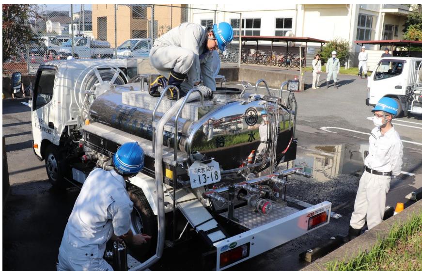
1. 消火栓から給水車へ注水
