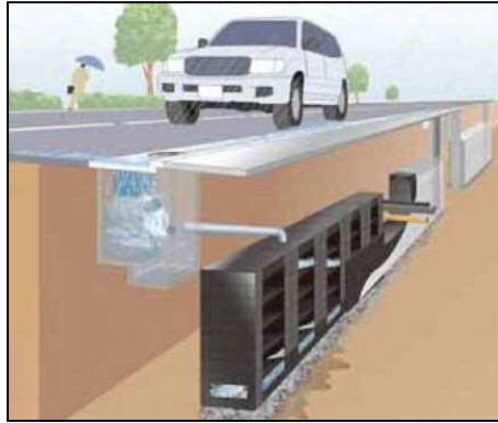
図 6-12 小型雨水貯留浸透施設（例）
