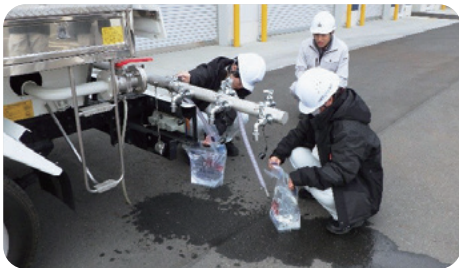
給水車による応急給水
