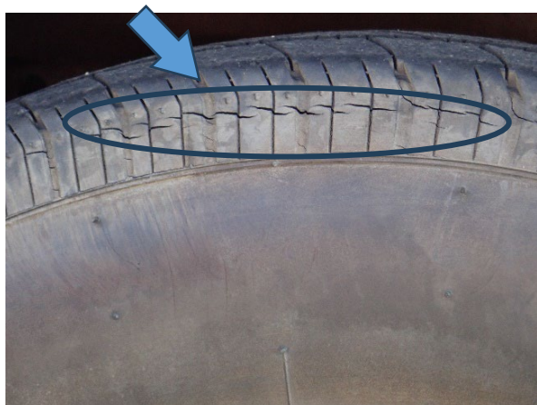
⑱ タイヤ詳細③ひびあり
