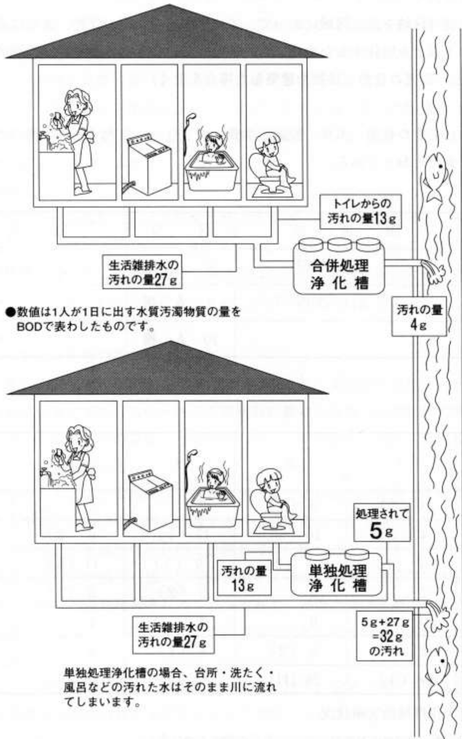
【合併処理浄化槽と単独処理浄化槽】
